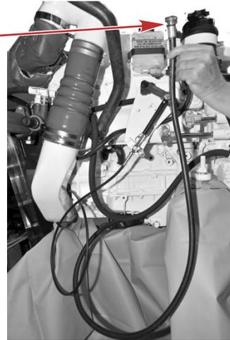
14. Die Motorölpumpe (separat zu bestellen) an den Kurbelgehäuse-Ölablassschlauch anschließen.
